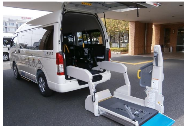
＜移送車3:後部リフトアップ＞
